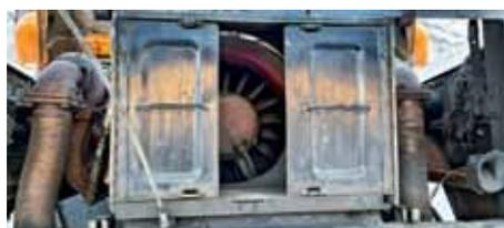
◀ Воздушные заслонки механического типа позволяют перекрыть часть потока холодного воздуха к двигателю. Осевой гидравлический вентилятор при температурах 115–117 °С охлаждает развал блока цилиндров
