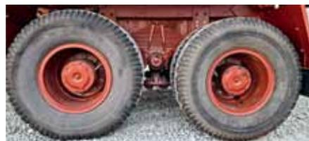
Подвеска задней тележки балансирующего типа. Суммарная нагрузка на мосты, оснащенные межосевой и межколесными блокировками, 26 тонн
