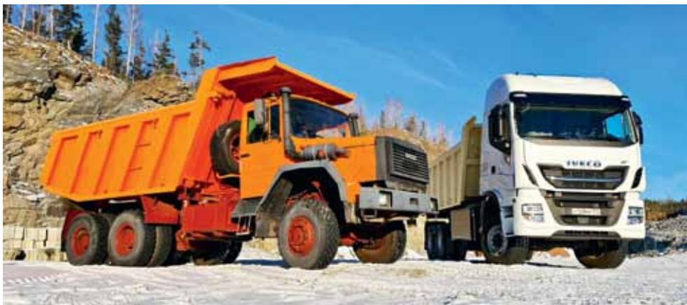
▲ Вчера и сегодня. IVECO 330.30 ANW родом из прошлого века и опытный образец самосвала (6x6) от ИВЕКО-АМТ, использующий в качестве моторного топлива компримированный природный газ (подробности в «КТТ» № 1/2021). Последний представляет собой симбиоз внедорожного шасси IVECO Trakker и спальной кабины AS (Active Space) от магистрального тягача IVECO Stralis. Так вот, рама и рессорно-балансирная подвеска мостов задней тележки с незначительными изменениями заимствованы у наследника Магируса
