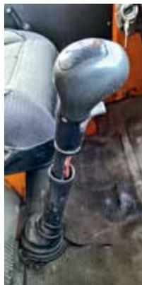
« Торчащий из пола рычаг 16-ступечатой КП ZF, переключающейся по схеме «2Н»
