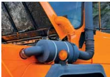
Фирменные особенности компоновки: отдельные воздухозаборники, выведенные вверх по передним стойкам кабины. При низких температурах подачу воздуха можно осуществлять из подкапотного пространства через желтые «гусакис»
