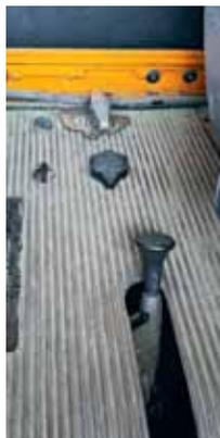
« Таким, прямо скажем, незатейливым образом выглядит «блок» стояночного тормоза, ручек межосевых и межколесных блокировок дифференциалов мостов, «понижайки» в раздаточной коробке и управления подъемом кузова, скомпонованный прямо на полу справа от кресла водителя
