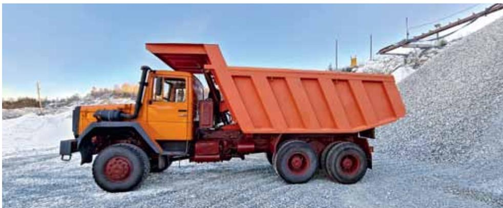
Наследник Magirus'a - тяжелый самосвал IVECO 330.30 ANW в арктическом исполнении. Сей, представленный на снимке, экземпляр в значительной степени базировался уже на агрегатах IVECO. Соответствующая комплектация позволяла эксплуатировать машину при температурах до  $-55^{\circ}\text{C}$
