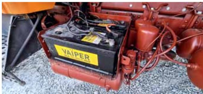
▲ Под крышкой аккумуляторного ящика две батареи. По логике ящик должен иметь подогрев...
