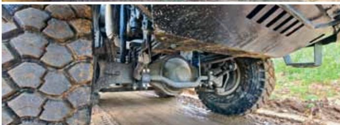
Заглянув спереди под самосвалы, у IVECO Trakker можно обнаружить «ушастую» балку, а у IVECO-AMT – 10-тонный кесслеровский мост. Но и там, и там защита радиатора, равно как и стабилизатор поперечной устойчивости
