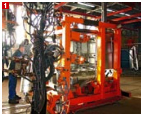
Кабина сваривается с помощью контактно-точечной сварки в специальном кондукторе (1). Сваренные кабины направляются на антикоррозийную обработку методом катафореза (2). Затем в особой камере проводят покраску кабин (3)
