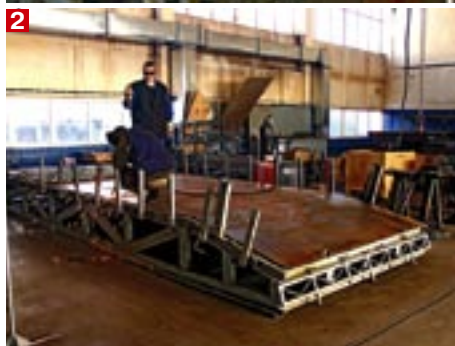
На стапелях сварочного цеха изготавливают комплекты самосвальных установок: днище, борта и надрамник кузова (1-2). Окончательная сборка кузова ведется на большом кузовном стапеле (3)
