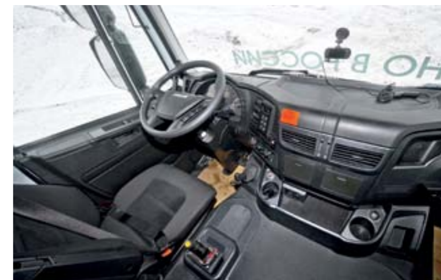
Интерьер типичен для Траккеров, справа от сиденья — рукоятка подъема кузова
