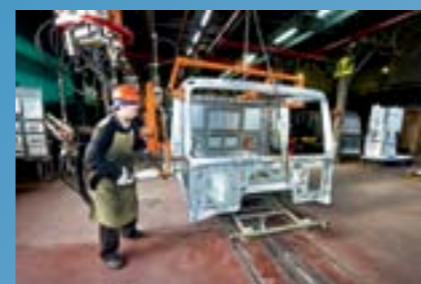
Кабины здесь изготавливают с нуля — варят и окрашивают, грунтуют в катафорезных ваннах
