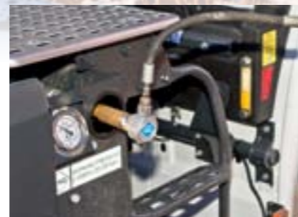
С правой стороны — заправочный штуцер (на фото — с переходником) и манометр
