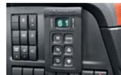
В переднюю панель встроен пульт управления «автоматом» Allison
