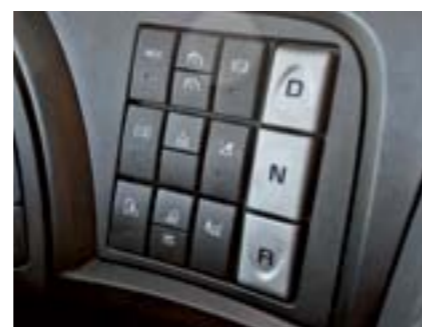
Здесь стоит привычный «робот» ZF TraXon
