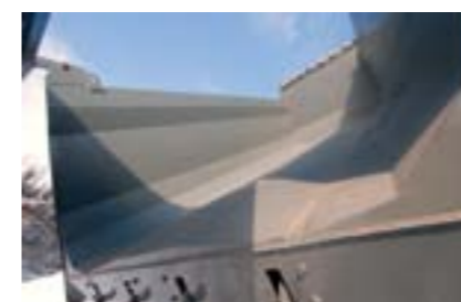
Днище кузова, как и полагается карьерным самосвалам, с контрпрогибом
