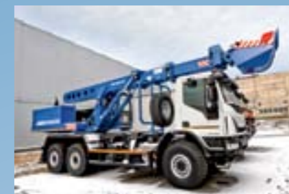
Еще один эксперимент завода: небольшой EuroCargo сделали трехосным, да еще и с экскаватором
