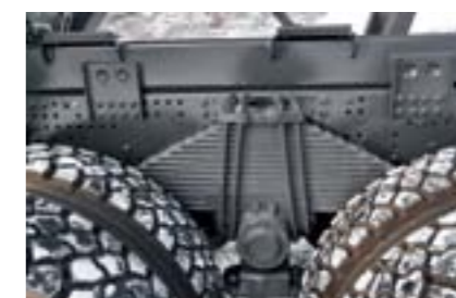
Рессоры — Чусовского завода, с необслуживаемым балансиrom
