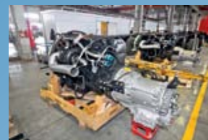
Двигатель IVECO плюс «автомат» Allison — сами ивековцы такого для тяжелых грузовиков не предлагают
