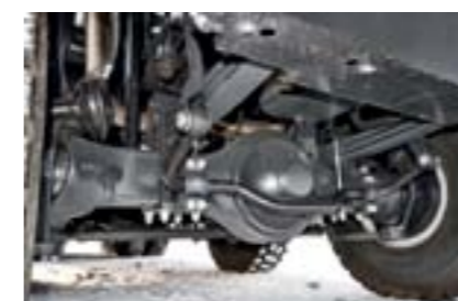
Мосты — немецкие Kessler, хорошо виден стабилизатор поперечной устойчивости
