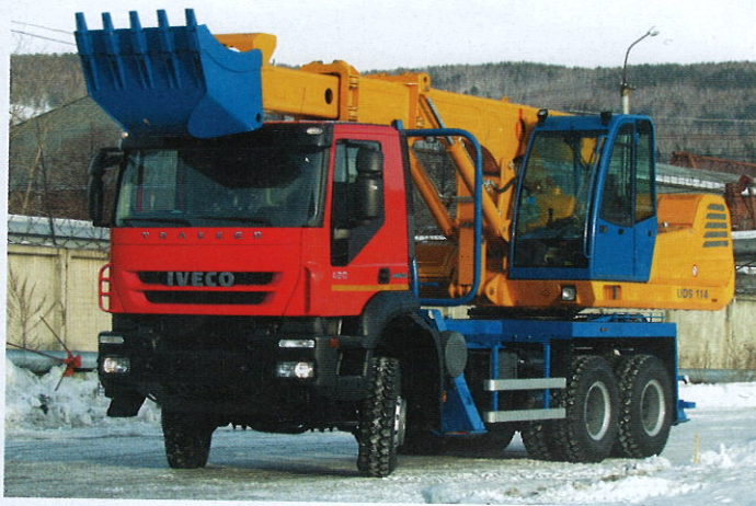
В прошлом году на «ИВЕКО-АМТ» начали производство Iveco Trakker с чешской экскаваторной надстройкой UDS 114. В этом году появится модификация машины с возможностью управления шасси из кабины экскаватора.
