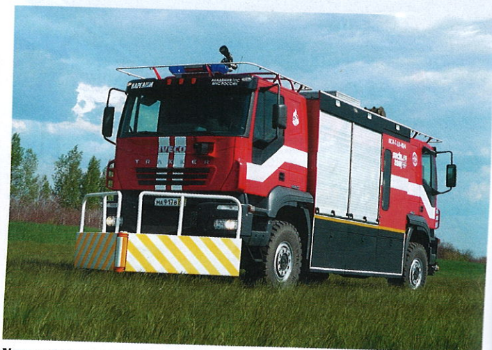
Уникальная разработка «ИВЕКО-АМТ»: пожарный автомобиль для работы в тоннелях с возможностью реверсивного движения.
