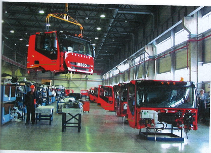
На сегодняшний день СП «ИВЕКО-АМТ» самостоятельно изготавливает кабины, осуществляя их сварку, грунтовку, окраску и сборку интерьера.
