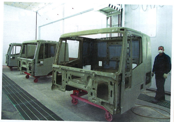
Современная камера для грунтовки и окраски. Пока ее задействуют при изготовлении кабин, а вскоре, после передачи их в отдельный цех, в этой камере будут грунтовать и красить рамы и различные надстройки.
