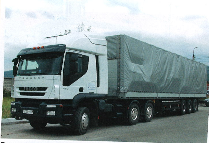
Одна из новинок «ИВЕКО-АМТ»: трехосный Iveco Trakker в версии магистрального тягача с задней пневмоподвеской и высотой «седла» под стандартный полуприцеп.
