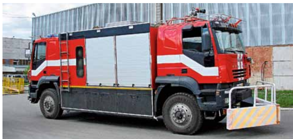
Уникальный пожарный автомобиль «ПСА-Тоннель» с реверсивным движением для тушения огня в тоннелях
