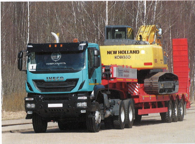
>>> Седельный тягач Iveco-AMT 633910 (6x6) с полуприцепом Политранс, загруженным 23-тонным гусеничным экскаватором New Holland
