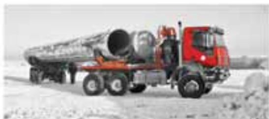
Трубоплетевоз «IVECO-AMT 633900» для перевозки труб, грузоподъемность 48 т.
