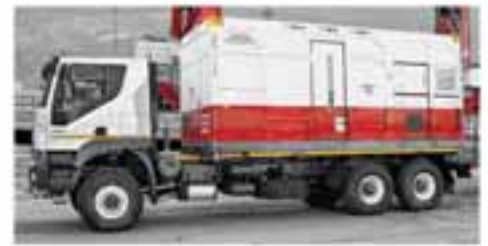
Контейнеровоз «IVECO-AMT 633940» для транспортировки различных контейнеров и емкостей.
