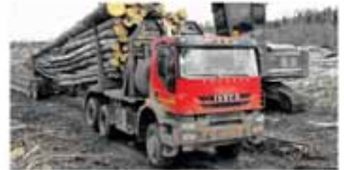
Лесовоз «IVECO-AMT 633930» для перевозки леса в хлыстах длиной до 27 метров
