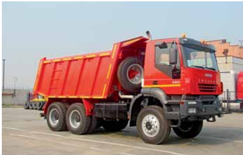
Самосвал на шинах 12R24 повышенной грузоподъемности
