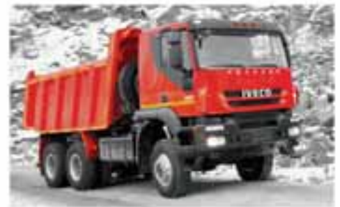
Самосвалы «IVECO-AMT 653900» грузоподъемностью до 22 т., объем кузова до 15 куб.м.
