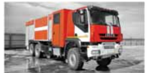
Пожарная автоцистерна «IVECO-AMT 6939» (АЦ-70, 100, 150).
