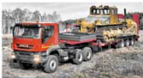
Седельный тягач «IVECO-AMT 633900», полная масса автопоезда до 97 т.
