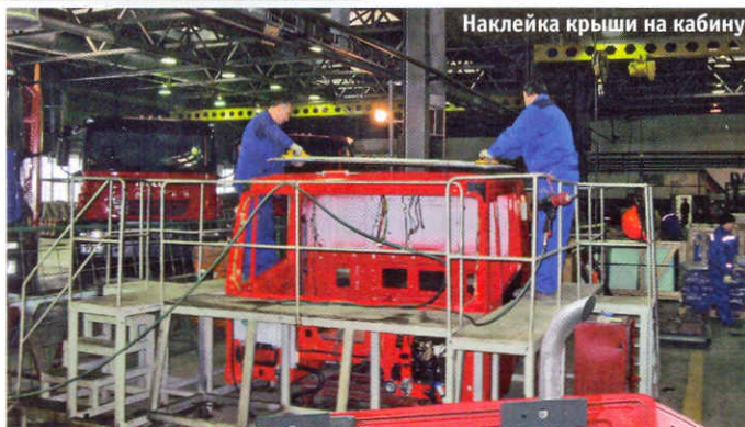
Кабина в кондукторе для сварки
