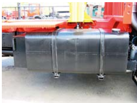
Топливный бак 500 литров, топливозаборник с электроподогревом
