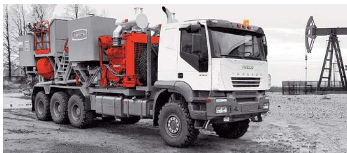
Шасси IVECO-AMT TRAKKER (8x6 с подкатной осью) Длина площадки для монтажа оборудования 9,5 м.
