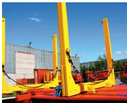
Коники со страховочными тросами, выдерживают разгрузку с помощью штабелеров
