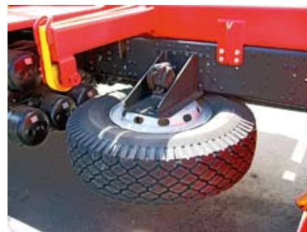
Запасное колесо расположено не на заднем свесе, а перед вторым мостом, чтобы не цеплялось за пни
