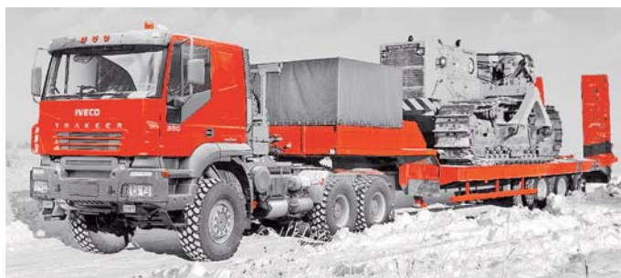
Седельный тягач IVECO-AMT 6339 (6x6, 6x4) Масса буксируемого полуприцепа – до 78т.
