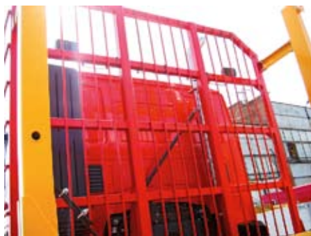
Задняя защитная стенка с фарами освещения рабочей площадки
