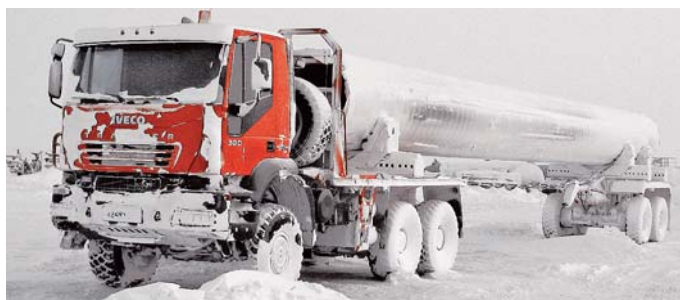
Трубоплетевоз IVECO-AMT 633900 (6x6) Длина труб до 36м, Ø 1420мм. Грузоподъемность 42т.
