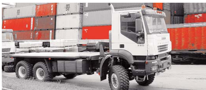
Контейнеровоз IVECO-AMT 633940 (6x6) для перевозки 20-футового контейнера. Грузоподъемность 20т.
