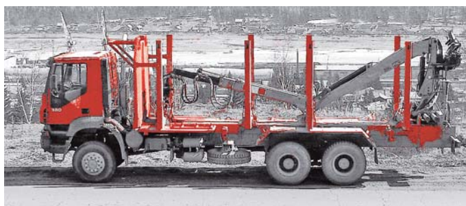
Сортиментовоз IVECO-AMT 633920 (6x6, 6x4) Возможна установка гидроманипулятора. Грузоподъемность до 26 т.
