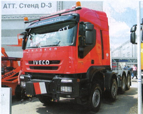
Балластный тягач Iveco Astra Sivi AT380 с колесной формулой 8х6, способный работать в составе 275-тонного автопоезда!
