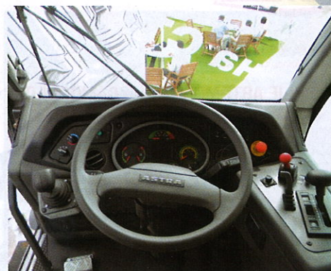
Руль, щиток приборов, ручка АКПП и пара педалей — все как в обычном самосвале: остается привыкнуть лишь к более чем 3-метровой ширине ТС
