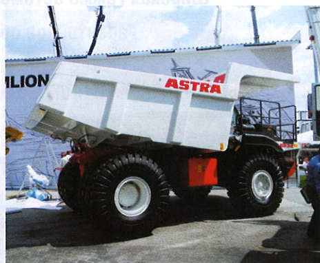
В кузове объемом 16 куб. м самосвал может перевозить до 40 тонн руды, скальной породы и других экстремальных грузов
