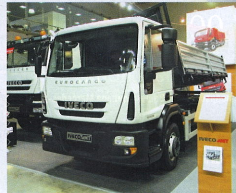
Новичок российского рынка самосвалов — среднетоннажный IVECO EuroCargo с самосвальной платформой, разгружающейся на три стороны
