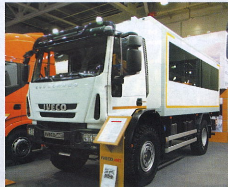
Среднетоннажник IVECO EuroCargo в полноприводном исполнении выступил носителем 22-местного вахтового пассажирского фургона
