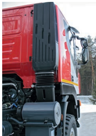
Забор воздуха в фильтр прямо из-под крыши. Оптимально для вездехода!
