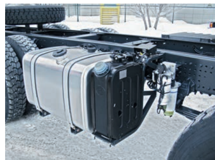
Топливные баки алюминиевые или стальные. И обязательно резервуар AdBlue
