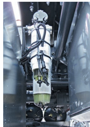
В топливной системе два фильтра предварительной очистки солярки
