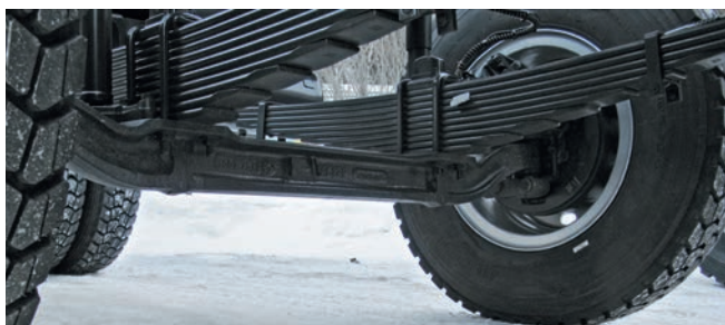
Передние неведущие управляемые мосты поставляют тоже в нескольких исполнениях по осевой нагрузке
