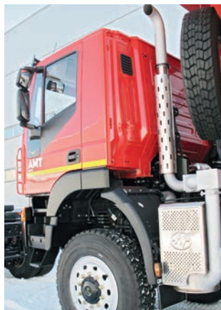
Есть три варианта размещения глушителя, но почти всегда выхлоп вверх
