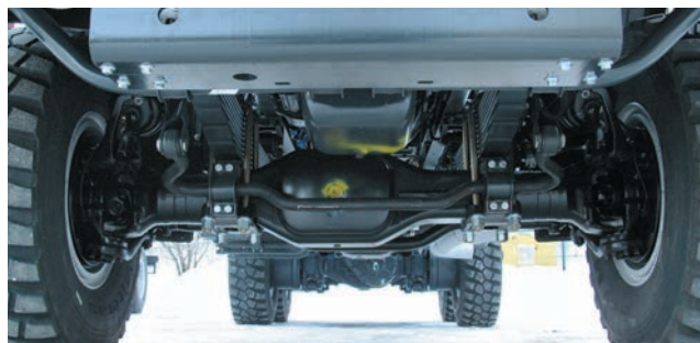
У передних ведущих мостов прочная литая стальная балка, мощный шкворневой узел. Оттого и нагрузку держат 9-10 тонн на ось
