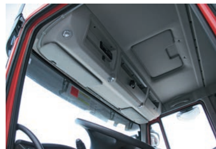
Над ветровым стеклом размещен неплохой блок ящиков и полок. В потолке – люк
