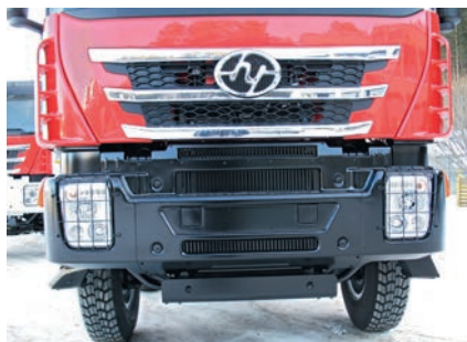
Правильный фасад: трехэлементный стальной бампер и боковые дефлекторы
