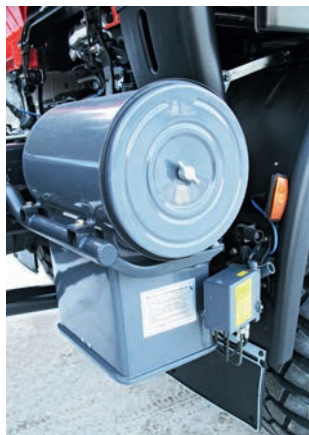
Воздушный фильтр двухступенчатый, а снизу – полезный противопылевый циклон
