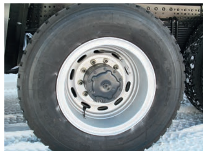
Здесь, похоже, пятисателлитный планетарный ступичный редуктор
