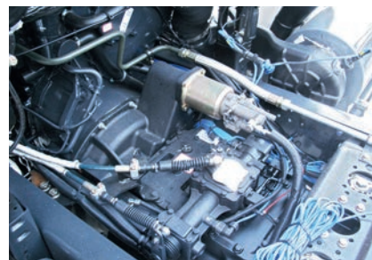
Коробки передач – 12-ступенчатые Fast Gear 12JSDX220TA на момент 2200 Н·м
