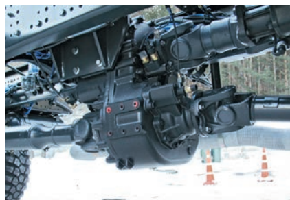
«Раздатки» производства Zhuzhou Gear – практически аналог ZF VG2000/300
