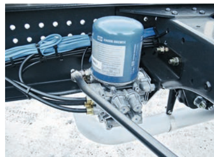
Блок подготовки воздуха – лицензионный Knorr-Bremse, изготовлен в Китае
