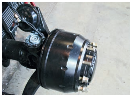
Даже на передних мостах применяются разжимные тормозные кулаки. Надежно!
