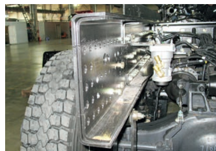
Рама сделана по схеме «лонжерон в лонжероне»: 8+4 мм или даже 8+8 мм
