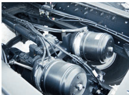
Тормозные энергоаккумуляторы «спрятаны» высоко в лонжеронах рамы
