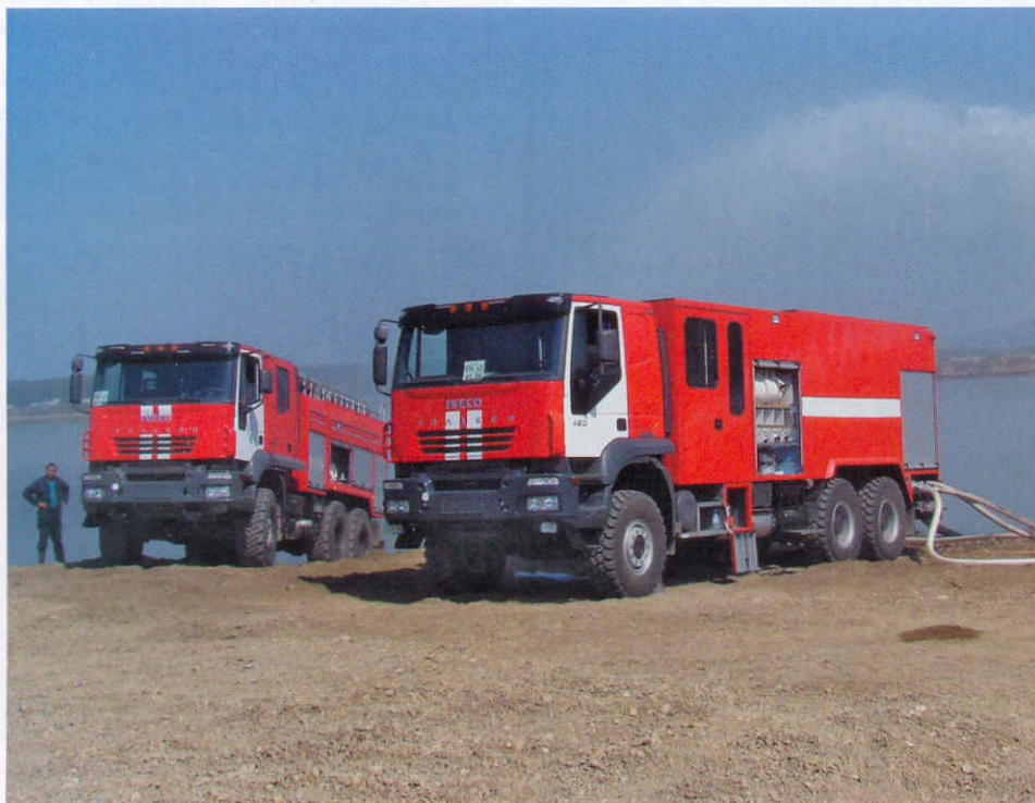
Специально для пожарного автомобиля разработано полноприводное шасси с двухрядной 4-дверной кабиной
