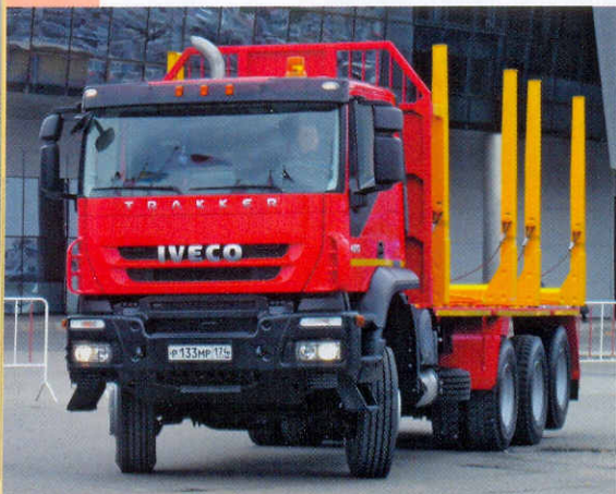
Шасси с четвертой поддерживающей осью IVECO-AMT 633903 (8x6), оборудованное сортиментовозной платформой
