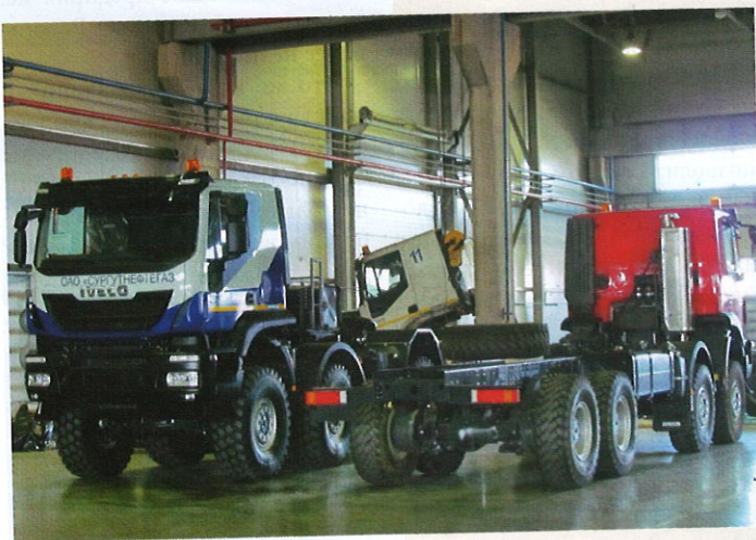
Как говорится, почувствуйте разницу: справа один из импортных Ivesco Trakker 8x8, а слева – уже переделанный из них Ivesco-AMT 733910, готовый к сдаче заказчику.
