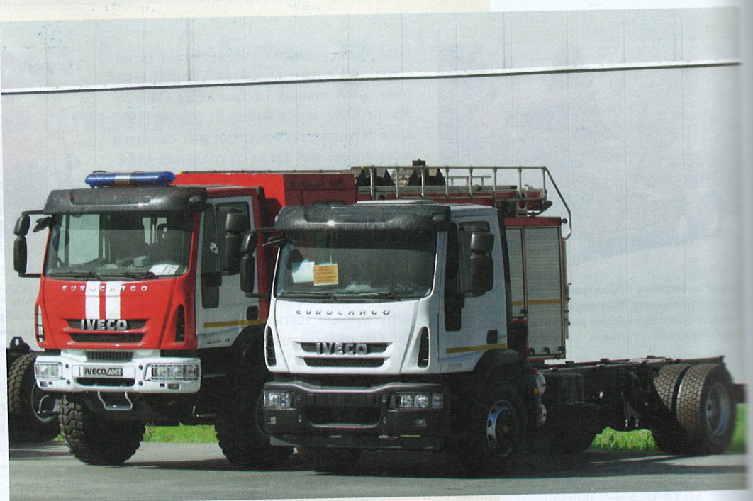
Самая тяжелая модификация Ivesco Eurocargo 4x2 для городской эксплуатации полной массой 18 т и внедорожный Eurocargo 4x4, уже превращенный в пожарную автоцистерну Ivesco-AMT 493910
