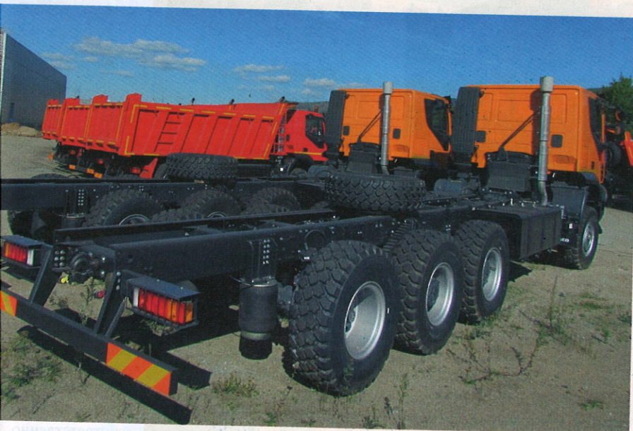
на стоянке готовой продукции четырехосные полноприводные шасси собственной раз- «АМТ» с задней теленной-тридемом. При снаряженной массе 11 500 кг их полная масса может кг.
