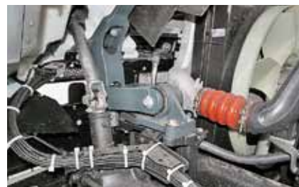
Петли подвески кабины складываются при ударе и гасят часть энергии
