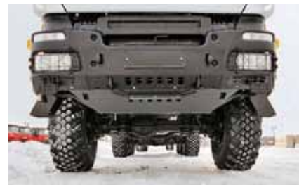
Стальной трехэлементный бампер дополнен мощным защитным листом
