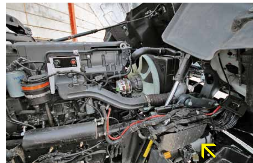
Миасские IVECO Trakker часто эксплуатируются в Сибири, на Дальнем Востоке, поэтому в базе ставят предпусковой подогреватель Eberspacher
