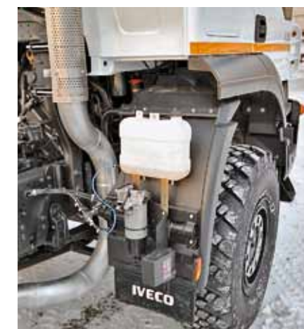
Один из вариантов расположения глушителя – вертикально, за кабиной
