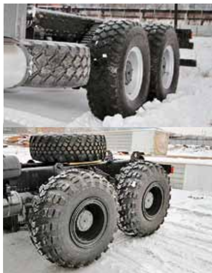
Однокатная ошиновка существенно улучшает проходимость на бездорожье
