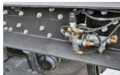
Кронштейны и усилители рамы крепятся на высокопрочных болтах
