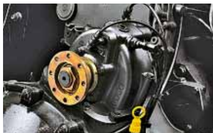
От GPM двигателя Cursor тоже есть возможность отбора мощности
