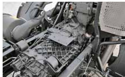
Коробки передач – немецкие 16-ступенчатые ZF 16S2220
