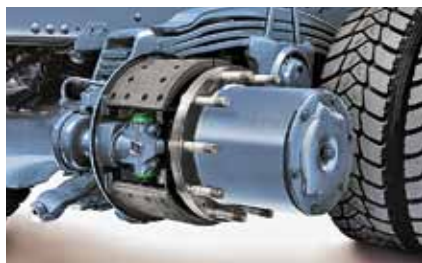
Тормозные механизмы у Trakker барабанные, с клиновым разжимом
