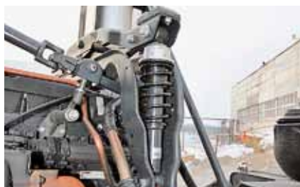
Подвеска кабины – на четырех пружинных стойках. Пневматика – у Stralis
