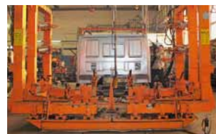
В этом кондукторе сваривают кабину. Теперь она современная, IVECO Stralis
