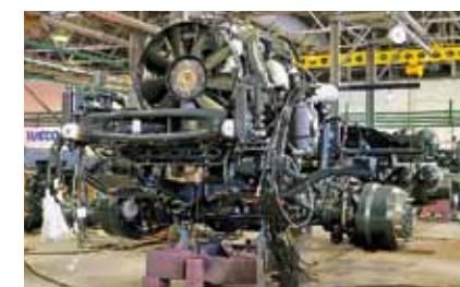
На небольшом конвейере рама постепенно обрастает агрегатами
