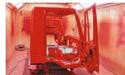
Кабину грунтуют электрофорезом на «УРАЛАЗе», но красят на СП
