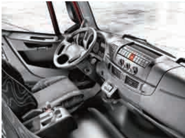
Рычаг 6-ступенчатой коробки передач вынесен на приборную панель (слева). Управление режимами трансмиссии расположено справа от сиденья водителя. С его помощью можно перейти на пониженную ступень «раздатки», заблокировать межосевой дифференциал и дифференциал заднего моста (справа)
