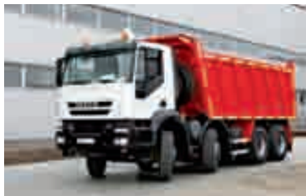
Самосвал IVECO-AMT 753901 (колесная формула 8x4) с кузовом производства ООО «ИВЕКО-АМТ» объемом 20 куб. м
