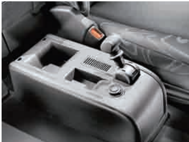
Рычаг 6-ступенчатой коробки передач вынесен на приборную панель (слева). Управление режимами трансмиссии расположено справа от сиденья водителя. С его помощью можно перейти на пониженную ступень «раздатки», заблокировать межосевой дифференциал и дифференциал заднего моста (справа)
