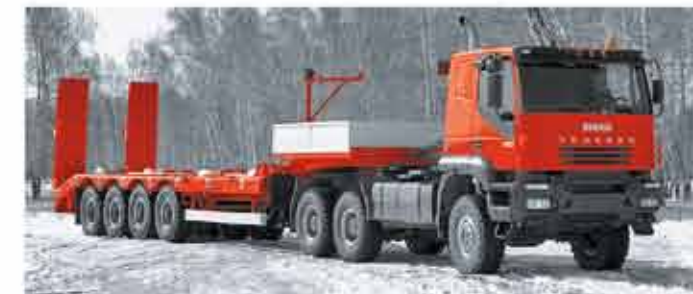
Седелный тягач «IVECO-AMT 6339» (6x6, 6x4) Масса буксируемого полуприцепа – до 78т.
