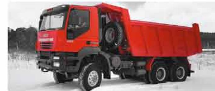
Самосвал «IVECO-AMT 6539» (6x6, 6x4) Объем платформы 12,8м³ и 15м³. Грузоподъемность до 25т.
