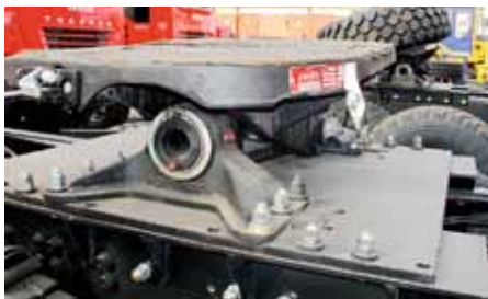
Сцепное устройство JOST с тремя степенями свободы для внедорожной эксплуатации автопоездов
