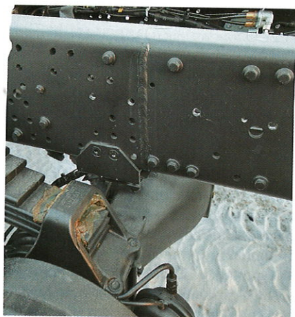
В этом месте лонжерон рамы сварен, но внутри установлены усилители
