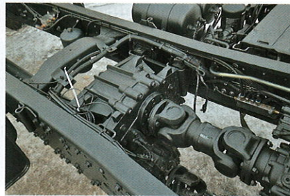
Коробка в сочетании с раздаткой обеспечивают автомобилю 32 передачи!
