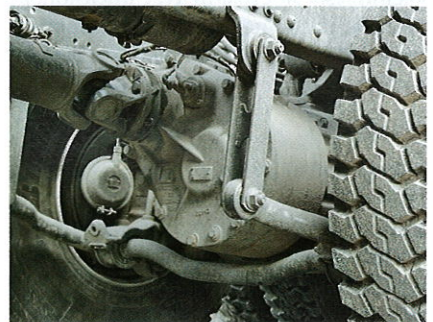
На самосвалы ставят пару стабилизаторов поперечной устойчивости
