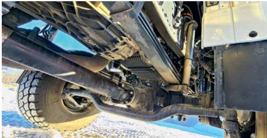
Передняя подвеска на малолитровых рессорах с амортизаторами и стабилизатором поперечной устойчивости
