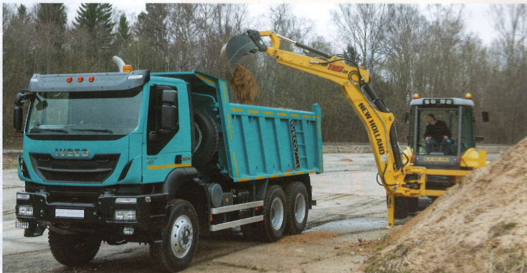
Новый Trakker в варианте трехосного полноприводного самосвала: изготовленный в Миассе Ivesco-AMT 653900 с 420-сильным дизелем, 16-ступенчатой КПП и 15-кубовой самосвальной платформой собственного производства, в которой можно перевозить до 23 т груза.
