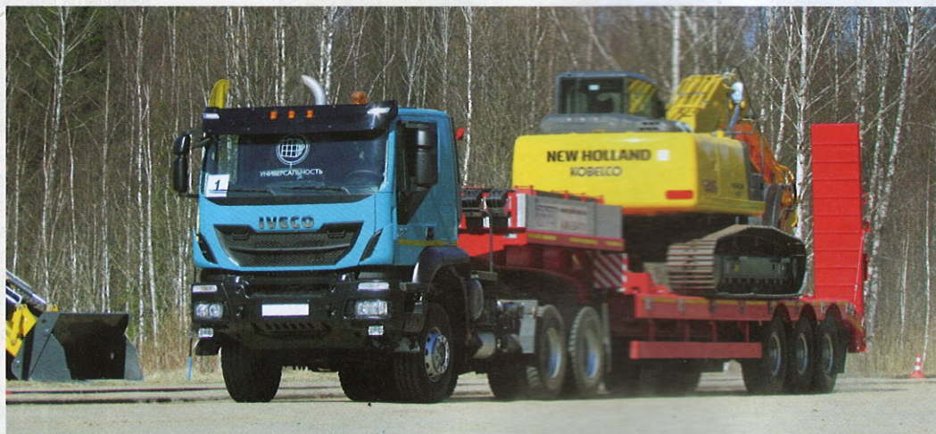
Ivesco-AMT 633910 – трехосный полноприводный седельник Trakker российского производства с дизелем Cursor 13 мощностью 420 л.с. и нагрузкой на ССУ до 27 т может буксировать полуприцеп массой до 85 т. Задняя подвеска – с использованием многорессорных стабилизатора поперечной устойчивости среднего моста.
