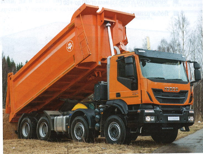
Iveco Trakker с колесной формулой 8x4 оснащен дизелем Cursor 13 мощностью 410 л.с. и 16-ступенчатой «механикой» ZF. Разгружаемый назад нубов геометрической вместимостью 21 м 3 – производства российской компании «Мультитран». Грузоподъемность самосвала 26 т, полная масса – 41 т (допускается конструкцией, соответственно, 33 и 48 т).
