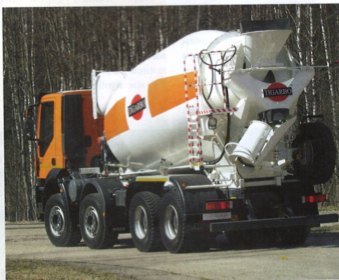
Бетоносмеситель Tigarbo с полезным объемом барабана 10 «нубов» смонтировали на четырехосном шасси Iveco Trakker с силовым агрегатом в составе 410-сильного дизеля Cursor 13 и 16-ступенчатой механической КПП производства ZF. Бетоносмесительный агрегат оборудован автономным дизелем Deutz, планетарным трехступенчатым редуктором ZF и немецким теплообменником АКГ.
