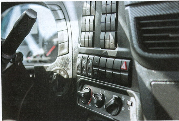
На центральной консоли – новые кнопки, справа на рулевой колонке – рычажок управления интардером
